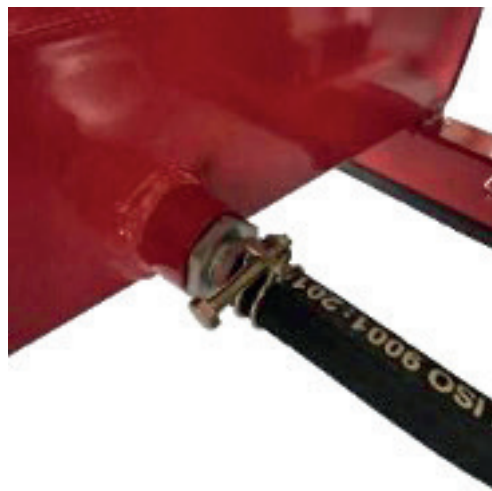
2. Trekk ut oljeslangen for å tappe olje.
